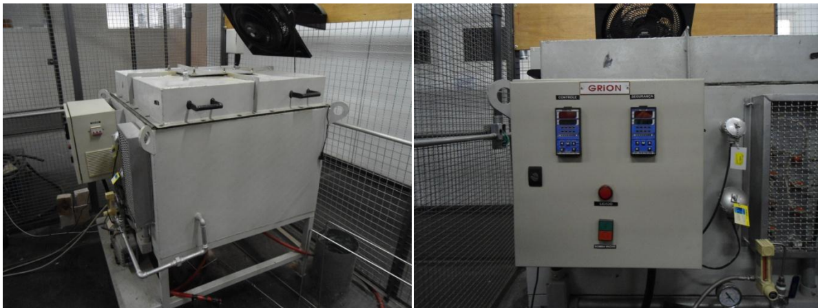
Figura 42. Forno usado para impor temperatura controlada ao experimento.
