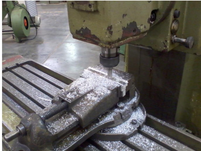
Figura 39. Fresamento dos corpos de prova para diminuição de espessura.
