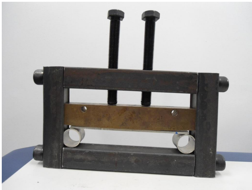
Figura 40. Mecanismo de simulação experimental de CAF.
