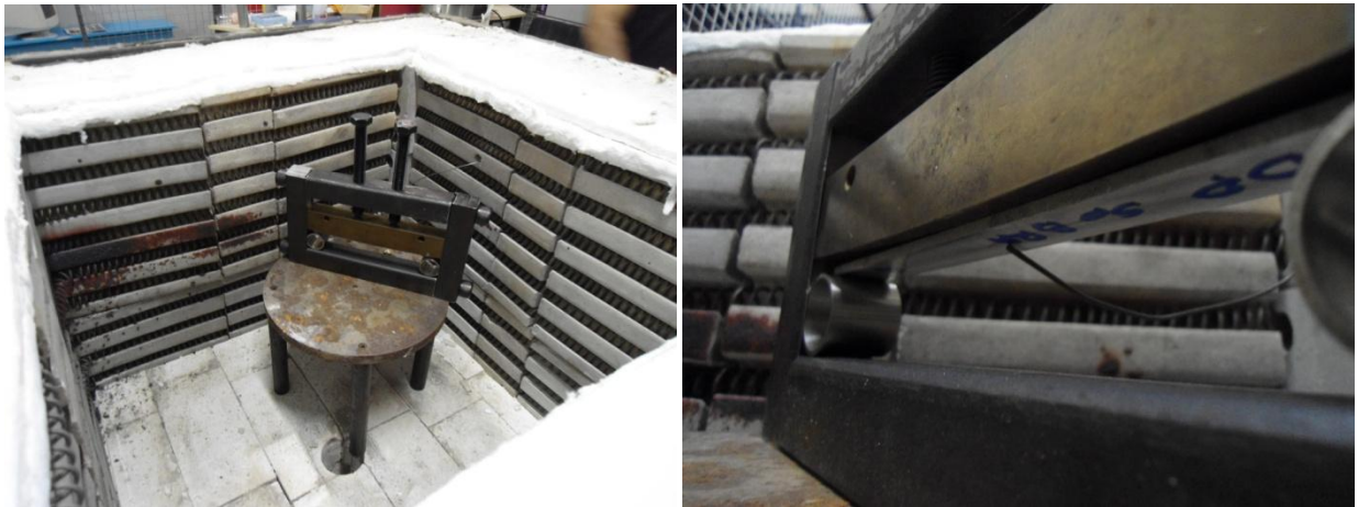
Figura 43. Posição do mecanismo dentro do forno e termopar em contato direto com o corpo de provas.
