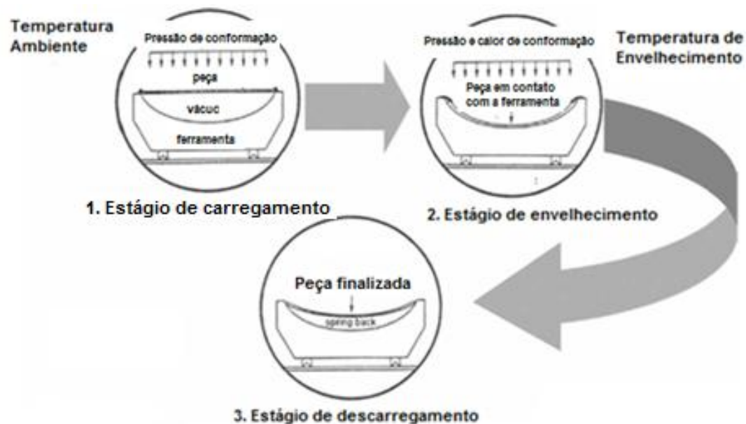
Figura 1. Etapas da conformação por CAF (Adaptada de Eberl, 2006).
