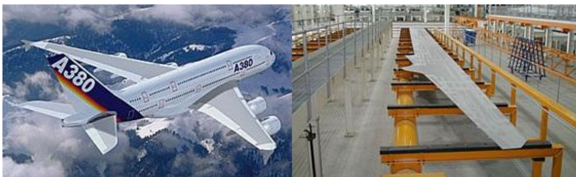
Figura 2. Airbus A380, maior avião comercial do mundo, e um painel de sua asa conformado por Creep Age Forming (Watcham, 2004).
